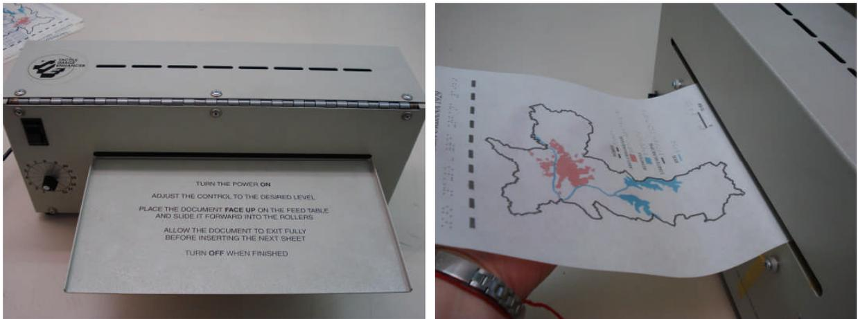
Figura 14 – À esquerda máquina Tactile Image Enhancer – Repro Tronics, Inc, utilizada para aquecer o material impresso, á direita mapa saindo da máquina com as linhas impressas em preto e em relevo
