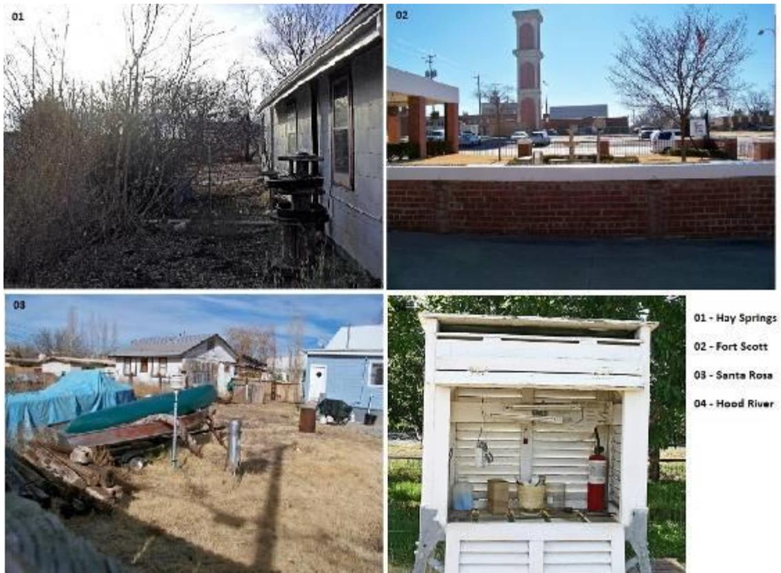
**Figura 12:** Representação da má localização das estações meteorológicas do tipo MMT (Minimum Maximum Temperature Sensor) da base de dados NOAA. Fonte: Anthony Watts (2007) In. [www.surfacestations.org](http://www.surfacestations.org)
