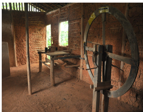
No interior da Casa de Farinha estão em exposição instrumentos utilizados no processamento da mandioca e na fabricação da farinha. A etapa de ralar a mandioca era composta da roda de madeira com veio de ferro, possuía uma corda para girar a roda ligada ao caititu (tritador) e o cocho de madeira como aparador da massa.
